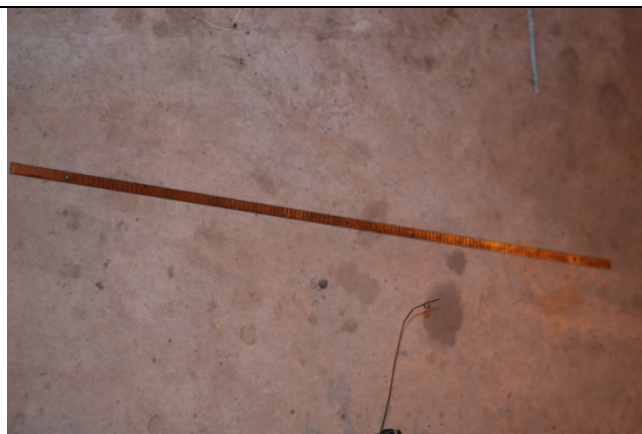
JÆG2006.06.167_20 Skinnen nederst på nålesengen. Den skrues fast.
