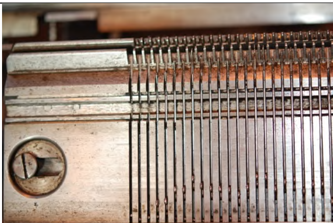
JÆG2006.06.167_17 Maskinen rengjort. Nåleskinnen er dradd ut
